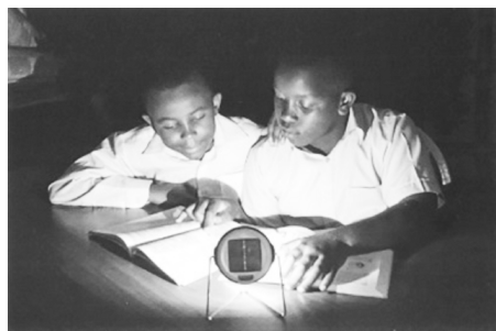
图 6 非洲儿童使用中国制造的太阳能灯学习 注:该太阳能灯使用了硅芯片技术,小巧且造价低,只需暴晒 8 小时便能提供 100 小时照明,使孩子们不必再依赖传统煤油灯。
